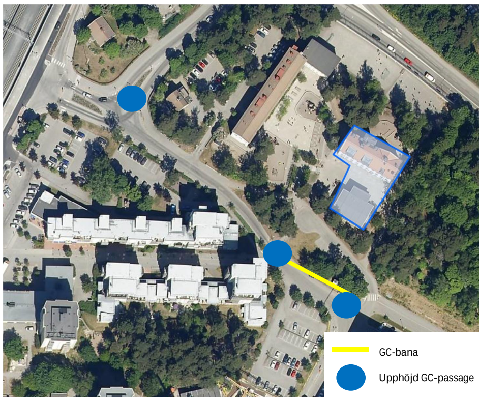
Bild 17. Förslag på åtgärder vid Ytterbyskolan.
